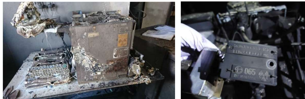
焼損したガスクロマトグラフ及び線源の状況
